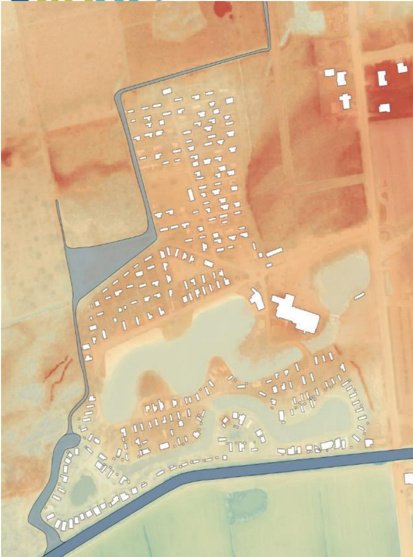
Meander als waterbergingsgebied (Waterbuffering gekoppeld aan grachtensysteem)
