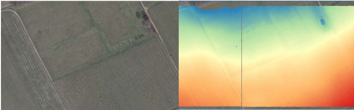
Figuur: luchtfoto (links) en hoogtemodel (rechts, in hoogte aflopend van rood naar blauw) van het grote grasland in het westelijke deel van het plateau. De afstroming gebeurt van zuid naar noord langs de aarden wegen aan linker- en rechterzijde. Aan de rechterzijde is een poel merkbaar (donkerblauwe vlek), en is te zien dat er tussen de laaggelegen weg en de poel een ruggetje (lichter ingekleurd) aanwezig is dat de instroom van water van weg naar poel belemmert. Zowel op de luchtfoto als op het hoogtemodel is te zien dat wat nu 1 grasland is vroeger uit meerdere percelen bestaan moet hebben. Daarbij komen ook 2 stroken van ca. 10m breed naar voor, die mogelijk vroegere grasstroken tussen de percelen aangeven die dwars op de afstromingsrichting georiënteerd waren.
